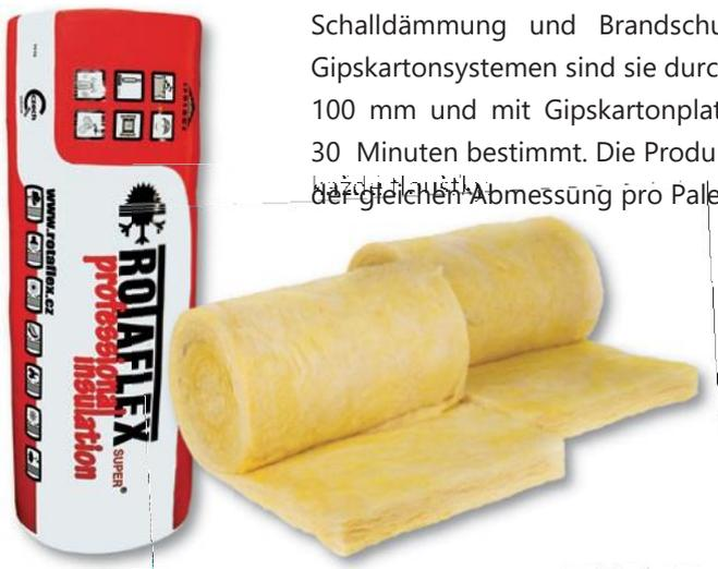
Schalldämmung und Brandschutz bei Innenausbau (Raumtrennwände, abgehängte Decken) Bei Gipskartonsystemen sind sie durch ihre Abmessungen, gemeinsam mit C-förmigen Metallprofilen 50, 75, 100 mm und mit Gipskartonplatten Typ F für leichte Trennwände mit einer Feuerbeständigkeit von 30 Minuten bestimmt. Die Produkte werden auf hölzernen Einwegpaletten verpackt geliefert – 18 Rollen der gleichen Abmessung pro Palette. Die Mindestbestellmenge ist 5 Paletten von jeder Dicke.
